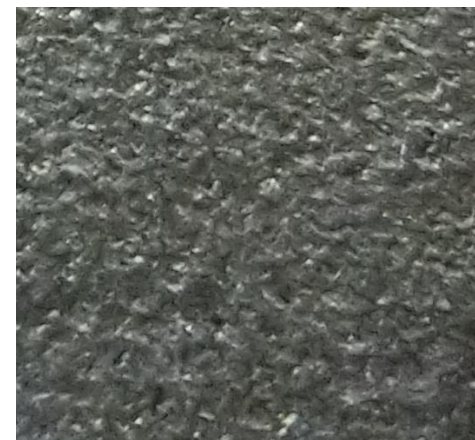
鍛工品のショットブラスト処理面
