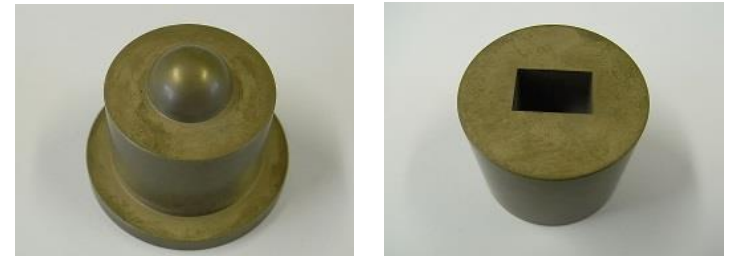
耐摩耗性材料の例 ホウ化物系無機化合物の焼結型
