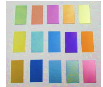
Tiの陽極酸化被膜 による干渉色
