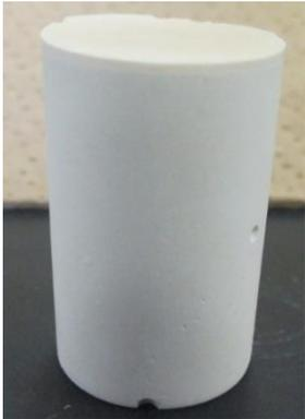
試作したジオポリマー試験片
