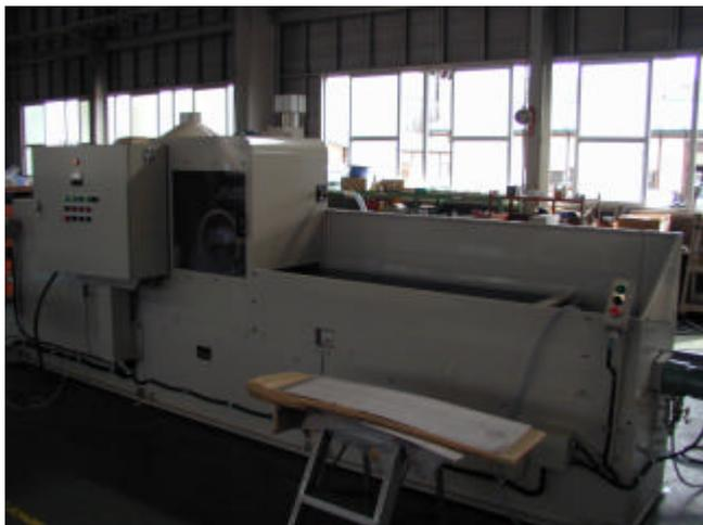
図1 マグネシウム圧延板用研磨装置
