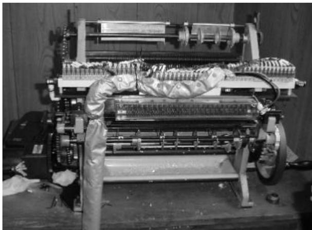
図 4 : エアーシリンダー式自動パンチングシステム
