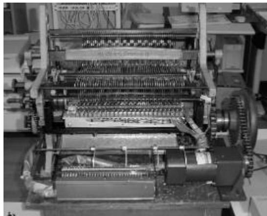
図 5 : 電磁ソレノイド式自動パンチングシステム
