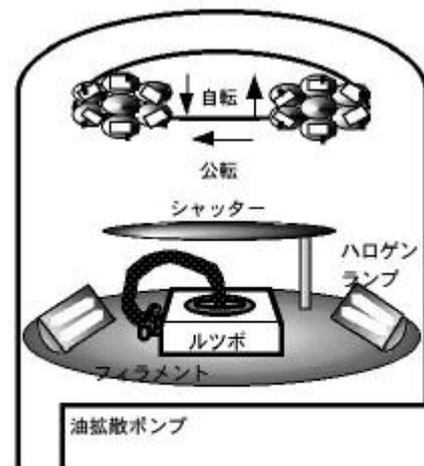
図 1 プリカーサ作製用 EB 蒸着装置模式図
