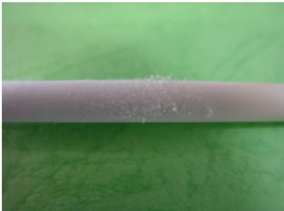
図7 熱電対保護管に付着した  $WO_3$
