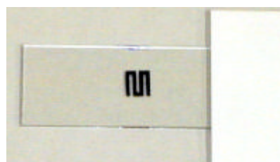
図2 スクリーン印刷による焼成膜
