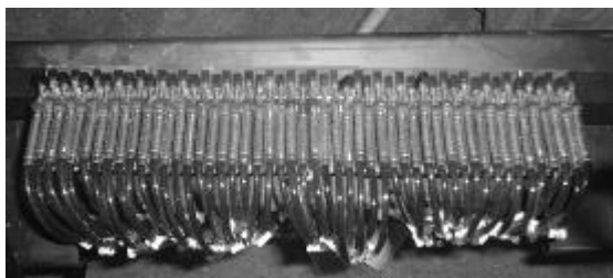
図3：フィラーニードルを制御するストッパー
