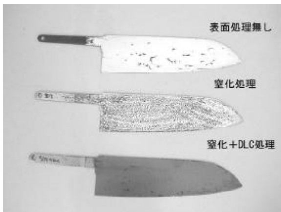
図 8 塩水噴霧試験結果（3 時間後）
