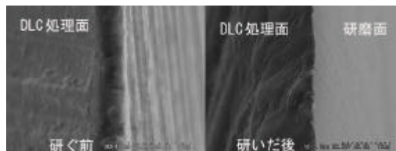
図6 片面DLC処理刃先の表面観察写真
