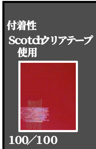
図4.4 陽極酸化膜の付着性試験
