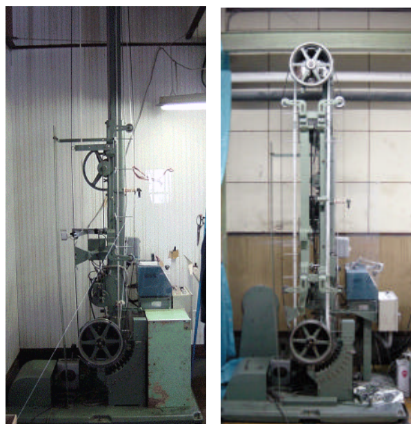
図5 見本整経機の構造 (左：改良前，右：改良後)
