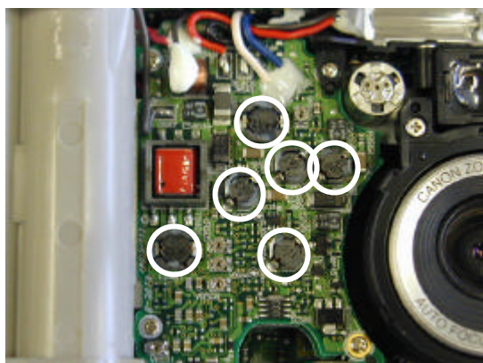
図 1. デジタルカメラに搭載されたインダクタ
