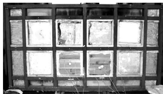
図7 複合壁材の燃焼試験状況
