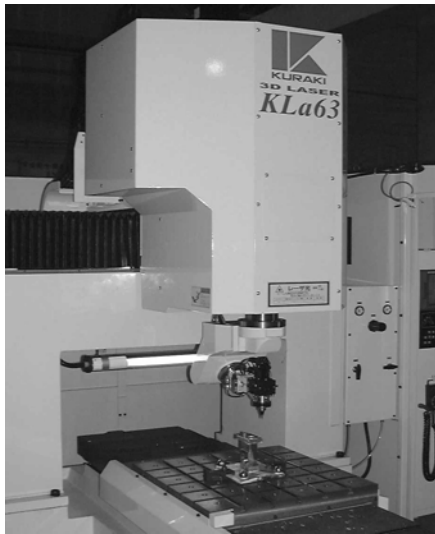
図7 実用化された高精度三次元レーザー加工システム
