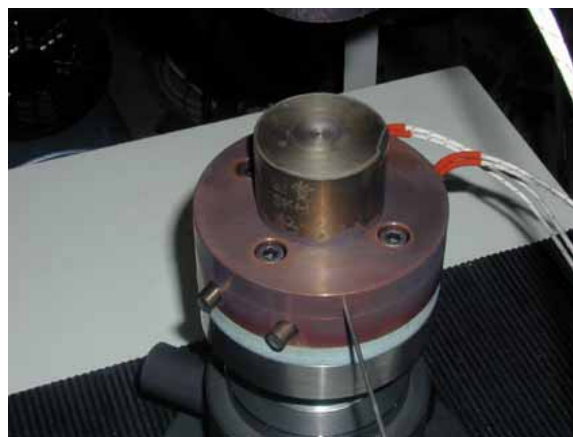
図3.1 端面拘束圧縮試験の金型（下側）
