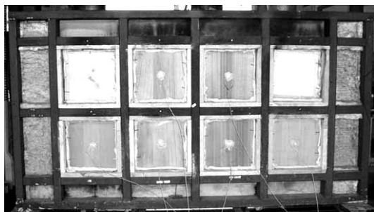
図4 幅接ぎ材の燃焼試験状況
