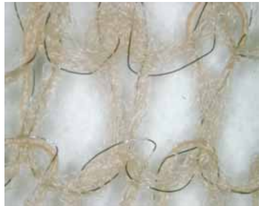
図9 モリブデンにポリエステルフィラメントを撚糸し、編み立てた導電性金属編み地
