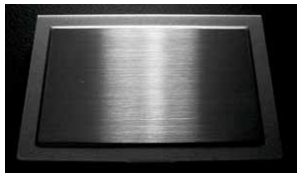
図4.1 ヘアライン加工と陽極酸化処理を 組み合わせた表面処理
