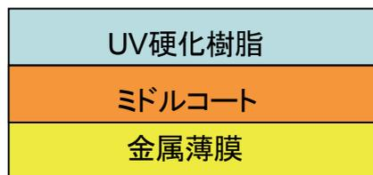
図 10 保護膜の構造
