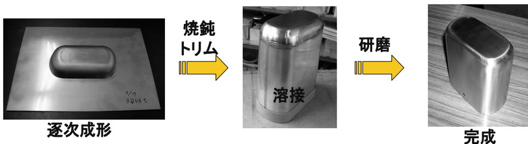
図 9 浄水器カバーの製作工程
