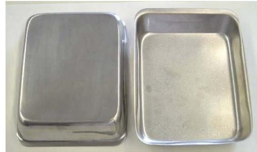
図7 Ni フリーステンレス鋼で試作したトレイ
