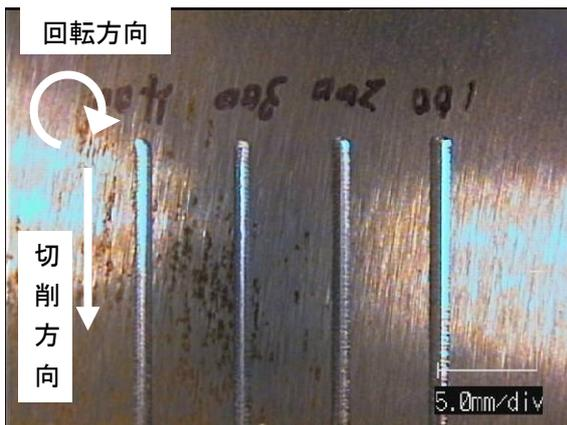
図 1 被削材上の切削痕 1
