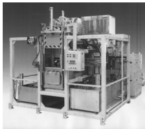
図1 アイスウォーターブラスト装置外観
