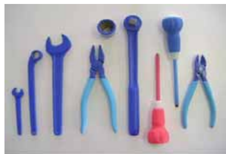
図1 ふっ素樹脂等で頭部まで極薄皮膜のコーティングを施した短絡防止絶縁工具の例
