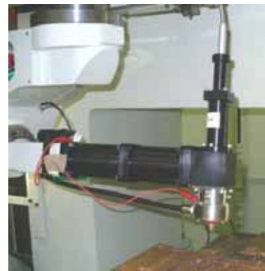
図 3 5 軸加工機の加工ヘッドに取付けた光学系の外観
