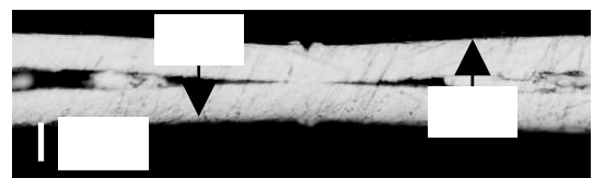
図8 板厚10 \mu mのステンレス鋼の重ね合わせ溶接断面(出力0.07W)
