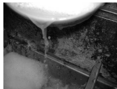
図4 油塊の鹼化分解実験 ：水酸化ナトリウム投入後
