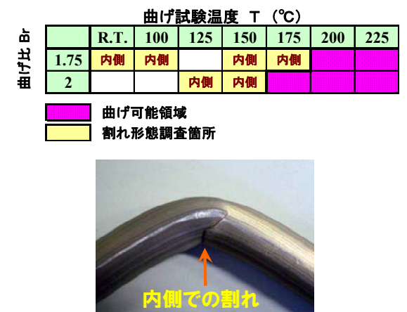
図 8 マグネシウム合金パイプの割れ形態
