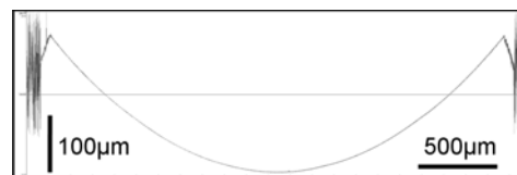
図 2 合成石英レンズの断面形状
