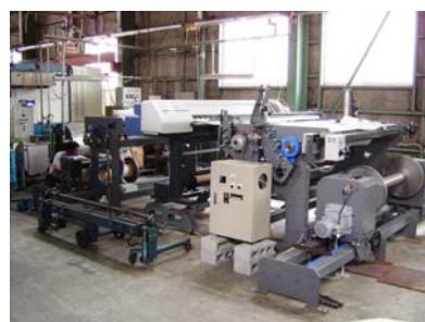
図1 たて糸捺染装置
