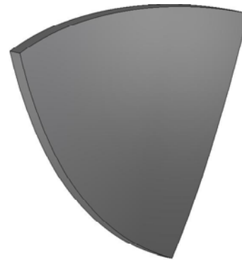
図 2 ボールエンドミルによる切り屑形状
