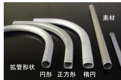
図 16 拡管曲げパイプ外観
