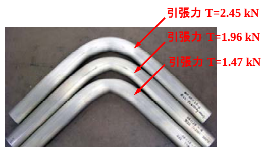
図5 パイプ引張り曲げ外観
