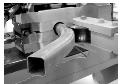
図 15 異形パイプ曲げ加工試験
