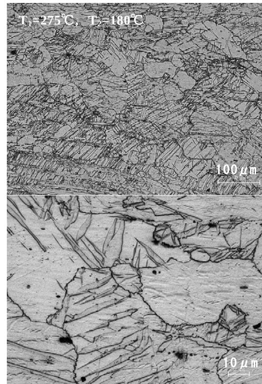
図 16 浮動拡管プラグ曲げ加工の金属組織（曲げ外側）
