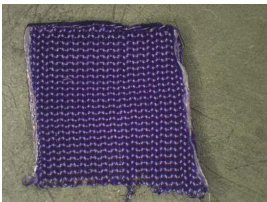
図 13 超音波切断後の足場
