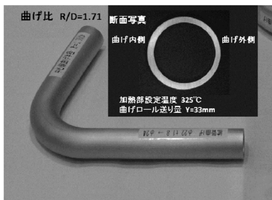
図 13 曲げパイプの外観および断面写真
