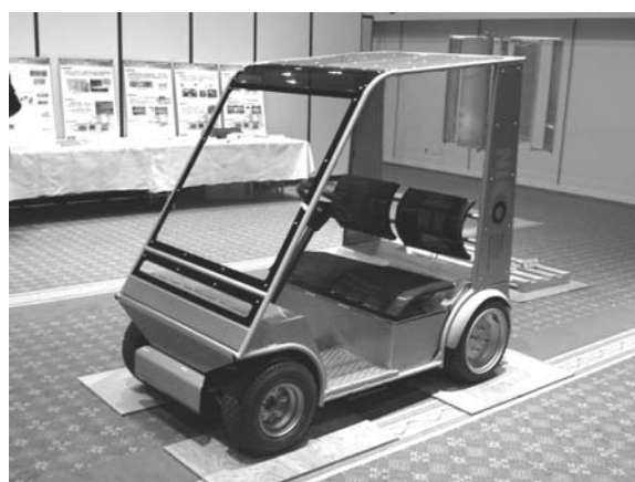
図 1 マグネシウム合金製電動カート
