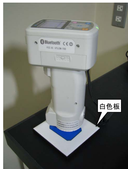
図4 透明な測定対象のための白色板
