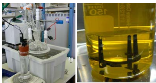
(a) 孔食電位測定 (b) 塩化第二鉄腐食試験
