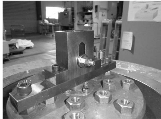
図 2 振動試験機に取り付けた試験ジグ
