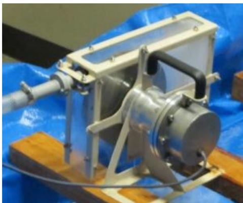
図2 可搬式水車発電機
