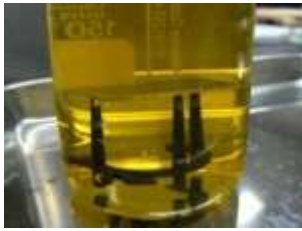
図2 塩化第二鉄腐食試験の様子
