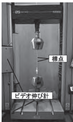
図3 伸び計の変位の測定
