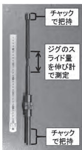
図2 伸び計の精度確認のためのジグ
