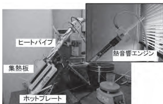
図 6 熱輸送実験装置
