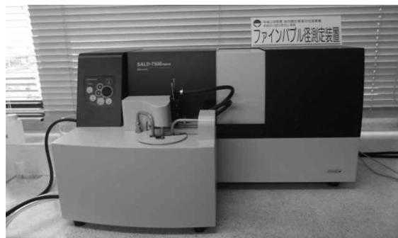
図4 ファインバブル径計測装置
