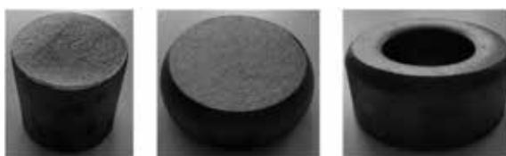
(a) 素材 (b) 据え込み (c) 後方押出
