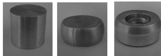
(a) 素材 (b) 据え込み (c) 後方押し出し
