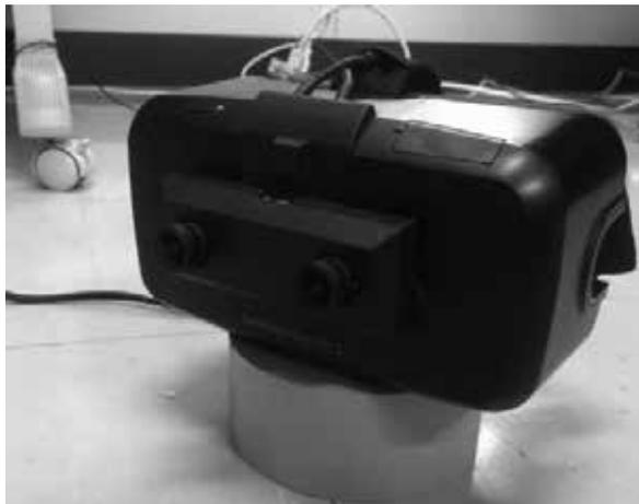
図 8 HMD とステレオカメラのコンポジット
