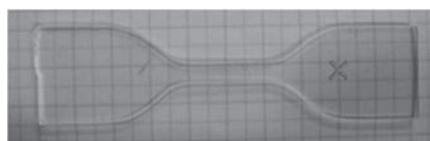
図 1 ダンベル試験片の外観 (平行部長さ 20mm, 幅 5mm, ×は温度測定部)
