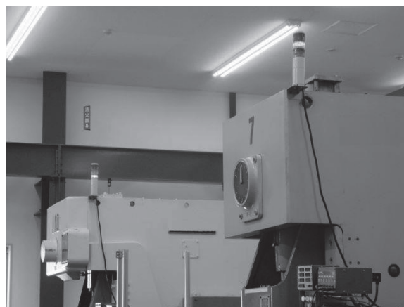
図3 機械の稼働状況を示すパトランプ
