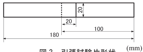
図3 引張試験片形状 (mm)
