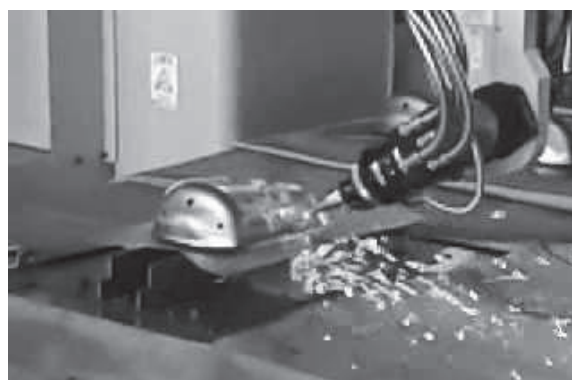
図5 レーザによる切断
