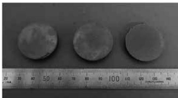
図 5 作製した樹脂硬化による試料
