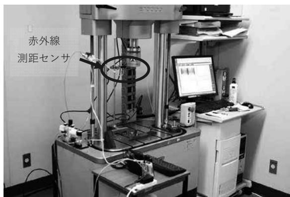
図 5 疲労試験 IoT 試行実験
