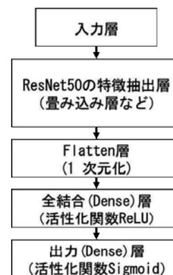
図 2 ResNet50 を用いた転移学習のネットワーク構造
