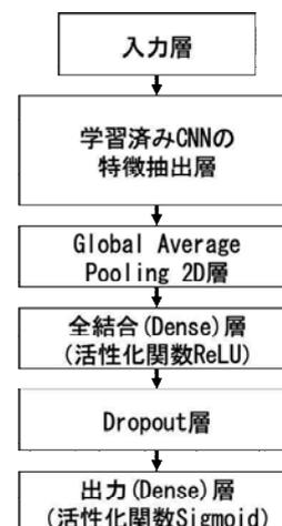
図 7 比較を行う際のネットワーク構造
