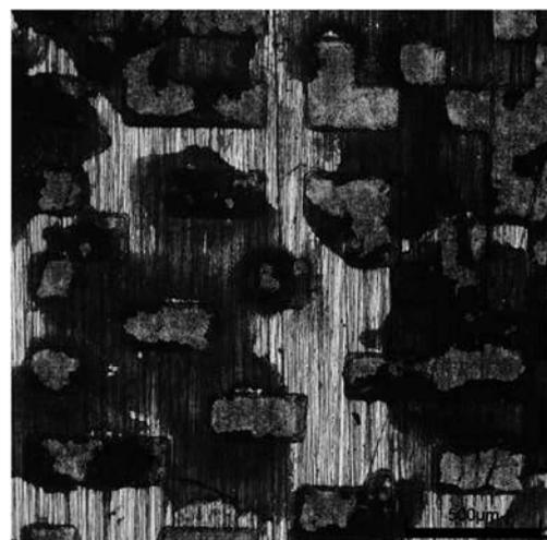
図 9 塩水噴霧試験後（UV レーザマーキング）
