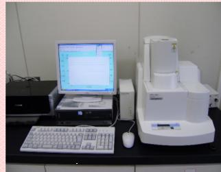
TG/DTAによる溶剤、塗工液の乾燥特性評価
