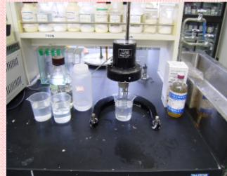
B型粘度計、ウベローデ動粘度計による溶剤、塗工液の粘度測定
