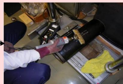
【熱サイクル試験後の評価】落球衝撃試験→ピンホール検出
