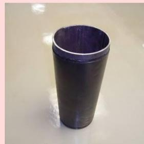
【試験品例】熱収縮チューブを被覆した鋼管
