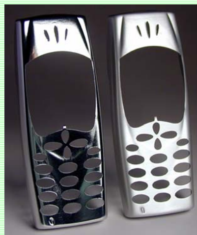
電解研磨後（左） 電解研磨前（右）
