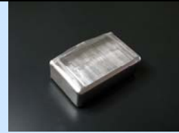
部分しごき後の角筒
