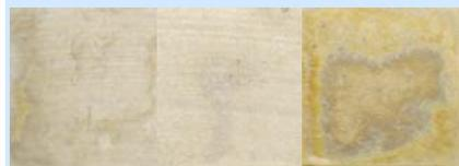
USCP(イオン液体) USCP(水) ウェットブラスト 複合サイクル試験後の表面
