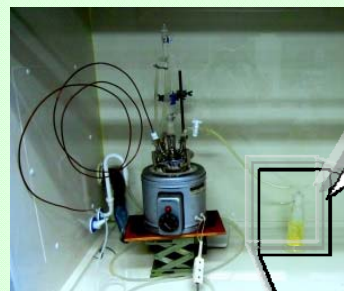
試作実験装置(不活性ガス(Ar)吹き込み)吸収液(純水)吸収生成物回収方式
