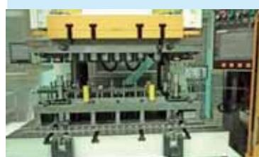
図3 プレス加工装置と順送金型
