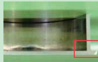
図3 成形品断面写真およびコーナ部拡大写真
