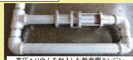
高圧ヘリウムを封入した熱音響エンジン
