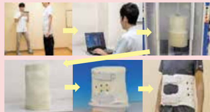
デジタル造形システムによる体幹装具の製作
