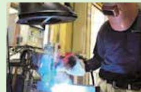
溶接時に発生するヒューム
