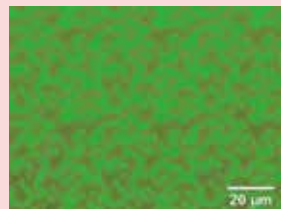
DOE回折格子の模擬形状 (電子線描画装置による描画パターン)
