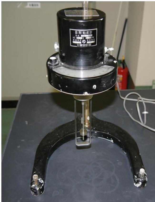
装置外観(中央部を液体に浸し、円筒または円板を回転させます。)
