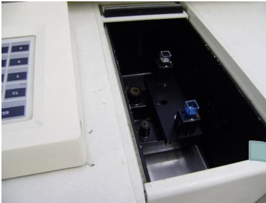
青色染料を溶かした水をセルに入れ、試料セット部へセットした状態
