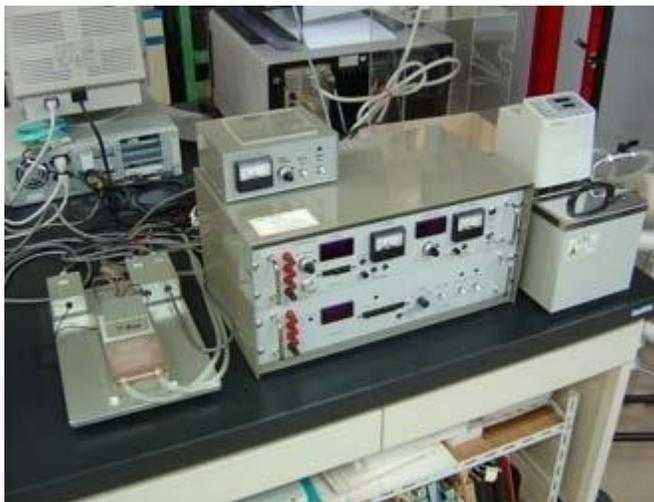
接触冷温感、熱伝導率測定部と制御装置
