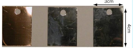
(a)Cu基板 (b)Niめっき膜 (c)Ni-ナノダイヤモンド複合めっき膜
