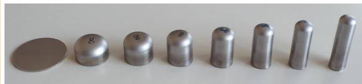
7工程成形試験結果（ダイス鋼試作金型）
