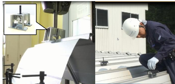
取付システムの試作と評価 強度や製作・施工上の問題点を検討
