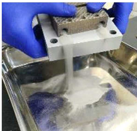
金属3Dプリンタによる金型造形
