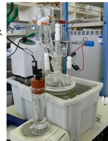
金属材料腐食試験装置の概略と外観
